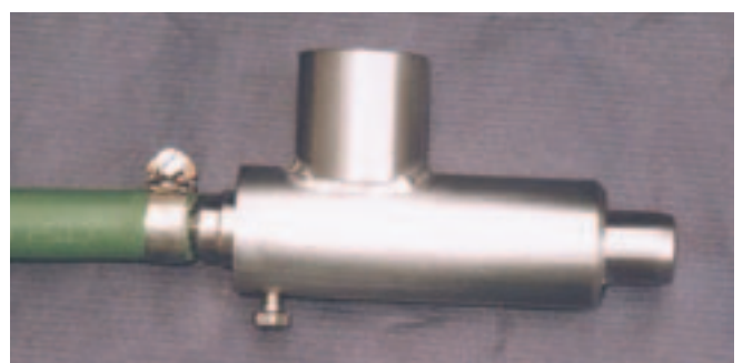
Abb. 6: Hochdruck-Injektor DN12 aus Edelstahl
